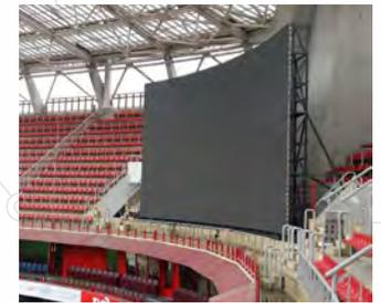
**Экран стационарный радиусный с задними площадками для обслуживания, крышного типа**
